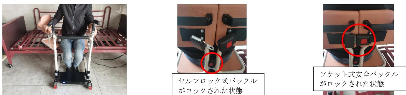
3) 使用者が完全に着座してダブルバックルがロックされたことを確認し、後輪ブレーキを解除した後、移動機をゆっくり移動させます。
