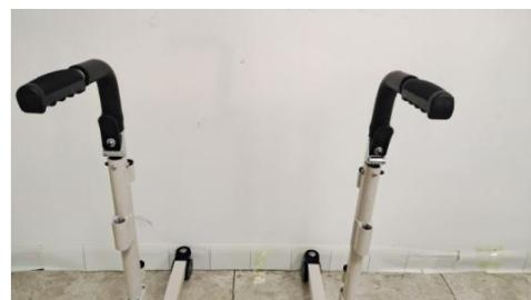
3) 安全ストッパー(手すり)を取り付けます。安全ストッパーの両端口を昇降主軸真ん中の固定管内に入れ、固定管の小穴に合わせて、黒いボタンを押しながら下に押し下げ取り付けます。凸部分が穴にはまり下図のようになります。
