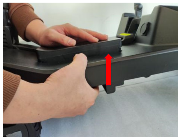
図9.バッテリーボックスの取り外し
