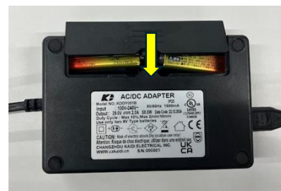
③乾電池を電池ボックスに取め、カバーを閉めてください。
