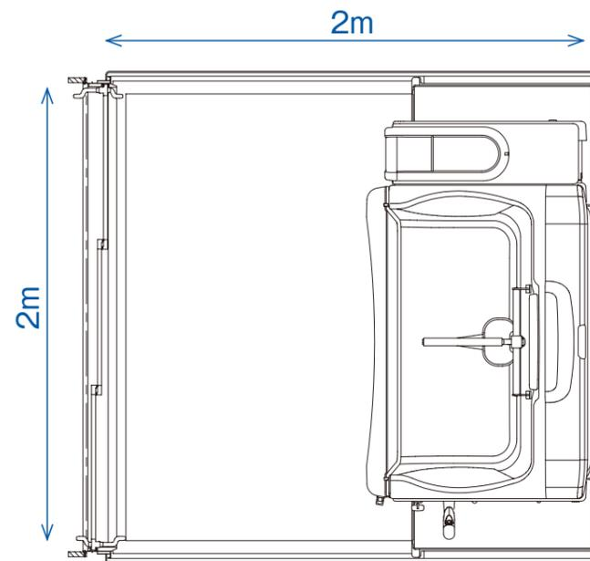
コンパクトな設計で、大きな空間を必要としないため、居住系施設・小規模施設へ簡単に設置可能です。ユニットバスにも設置できるため、防水工事が困難な場合も最適。幅広くさまざまな施設での利用が可能です。
